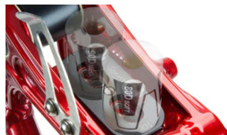
Élastomère double sur trikes 26" Sprint équipés de la cale d'épaisseur Sprint
