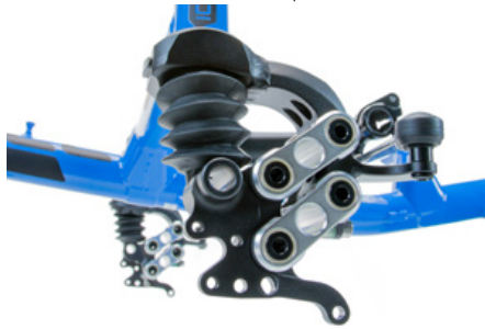
Pivot de direction avec suspension
